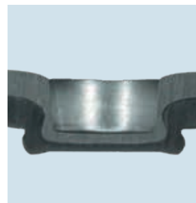
Schliffbild einer zweilagigen Clinchverbindung R-DF / Cross-section of a two-layer connection R-DF
