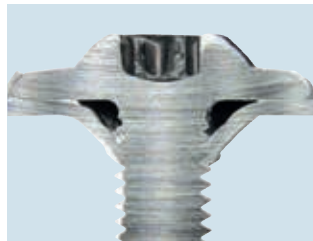
Zweistufiges Verfahren: Schlibbild der geschraubten Presswerkprüfung / Proceso de dos fases: Micrografía del tornillo enroscado mediante estampado por extrusión
