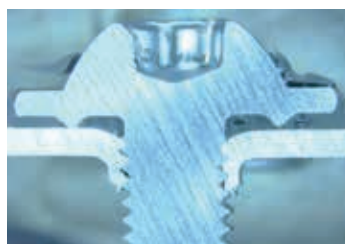
Schliffbild einer Direktverschraubung Micrografía de una unión atornillada directa
