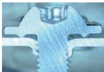
Schliffbild einer Direktverschraubung
