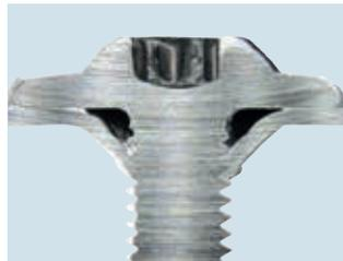
Zweistufiges Verfahren: Schliffbild der geschraubten Presswerkprüfung /
