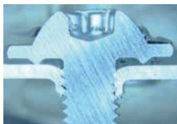
Schliffbild einer Direktverschraubung
