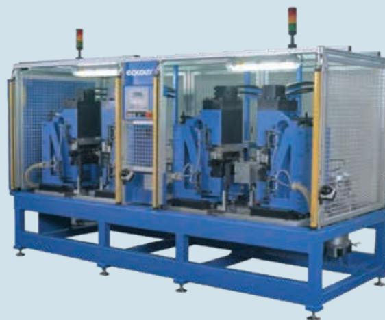
Clinchvorrichtungen und Anlagen / 咬合连接装置和机器
