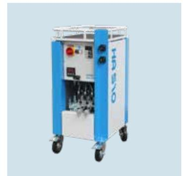
Hydraulikaggregat zum Antrieb der Falzzange
