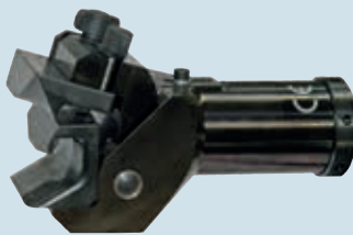
Individuell angepasste Falzeinsätze (Falzbacke – Oberteil (1), Führungsbacke (2), Unterbacke (3)) Individually adjusted seamclosing inserts (seamclosing jaw – upper part (1), guide jaw (2), bottom jaw (3))
