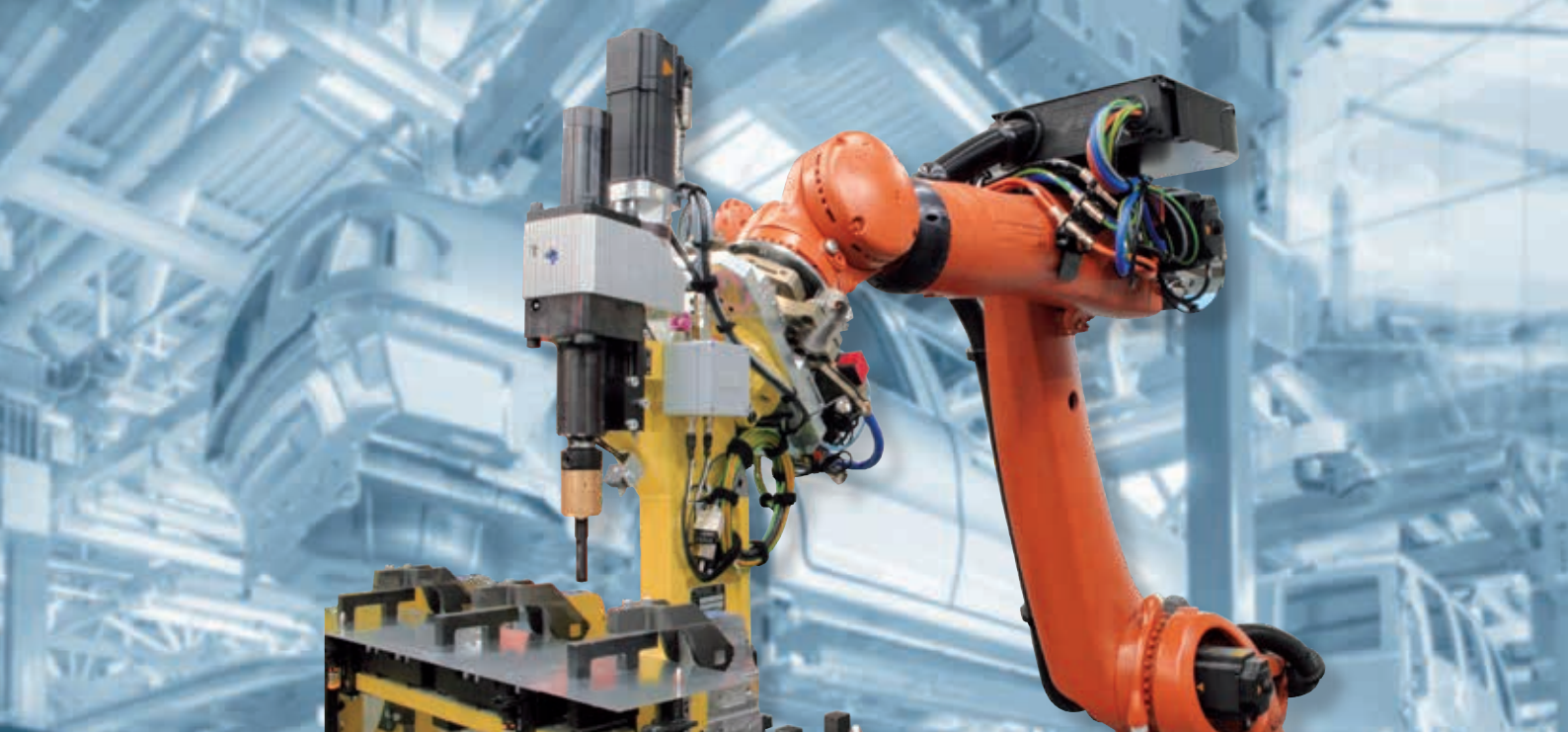
Servomotorisches Clinchsystem mit Prozessüberwachung und Visualisierung / Servo motor-driven clinching system with process monitoring and visualisation
