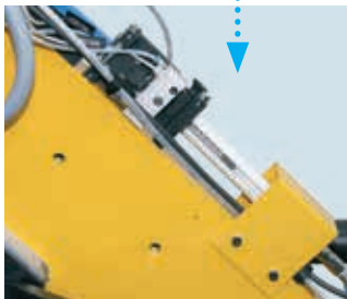
Nietmagazin / Depósito de remaches
