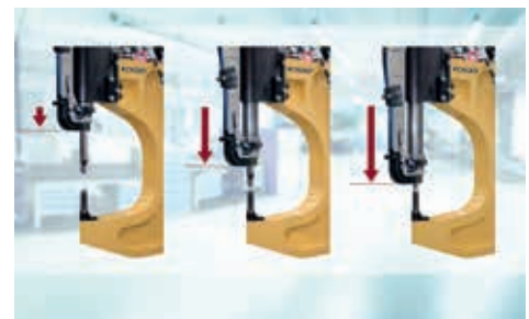
Variable Nietzuführbogen-Verstellung / Ajuste variable del codo de suministro de remaches
