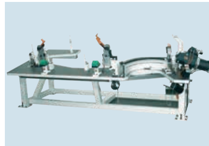
Seitenwand Radlauf Side panel with wheel house
