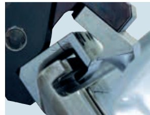
Mobile Falzzeuge im Einsatz Portable seamclosing pliers in operation
