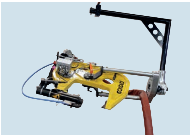
Große Flexibilität durch Dreh- und Schwenkvorrichtung High degree of flexibility due to a turn/swivel device
