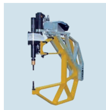
Estribo de construcción ligera
