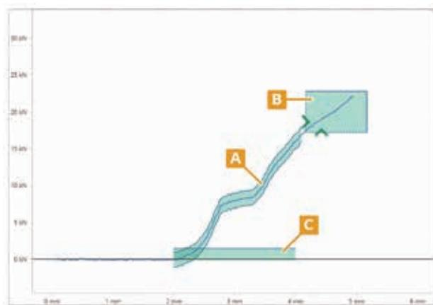
Prozessüberwachungsverfahren: Hüllkurventechnik (A), Fenstertechnik (B), Trendüberwachung (C) / Process monitoring methods: Envelope (A), window (B) and trend monitoring (C)
