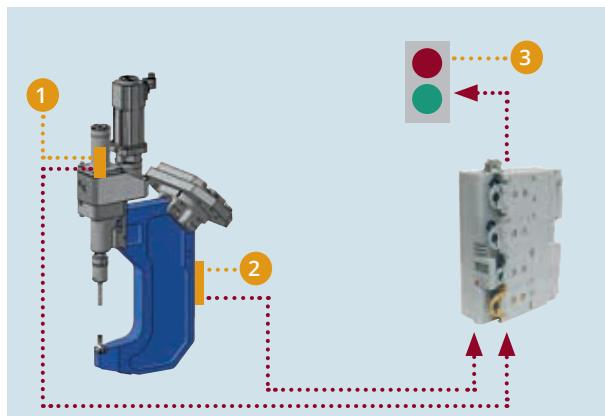
Überwachungsprinzip: Wegsignal (1), Kraftsignal (2), Prozessüberwachung (3)
