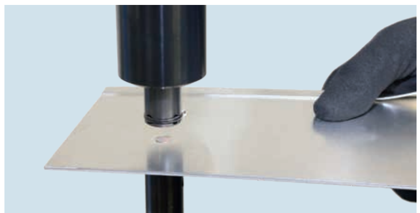
Stanznieten mit dem Multifunktionsgerät Self-piercing riveting with the multi-function unit
