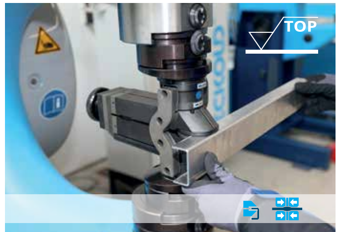
Stauchten von U-Profilen mit geringer Steghöhe, ausgerüstet mit Kunststoffstollen / Shrinking of U-profile sections with low web height, equipped with plastic jaws Schnabelwerkzeug / Beak-shaped shrinking tool KSL 60 S
