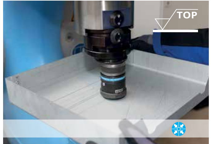
Spannen von Blechen durch konzentrisches Stauchen. Ausgerüstet mit Kunststoffstollen / Flattening sheet metal by means of concentric skinking, equipped with plastic jaws Spannwerkzeug / Flattening tool LFS 60 S
