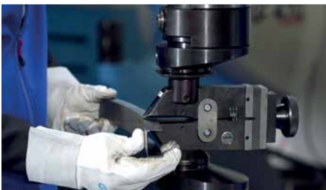
Strecken von U- und T-Profilen, ausgerüstet mit Stahlstollen / Stretching of U- and T-profile sections, equipped with steel jaws Schnabelwerkzeug / Beak-shaped shrinking tool KSR 80 T
