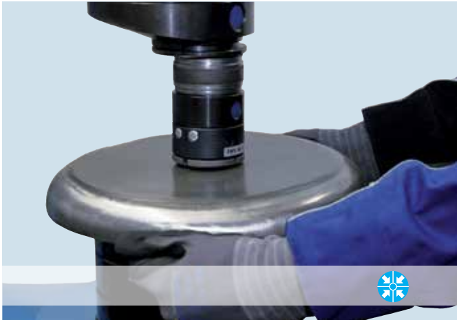
Spannen von Blechen durch konzentrisches Stauchen / Flattening sheet metal by means of concentric skinking Spannwerkzeuge / Flattening tools FWS 60 S, 80 T
