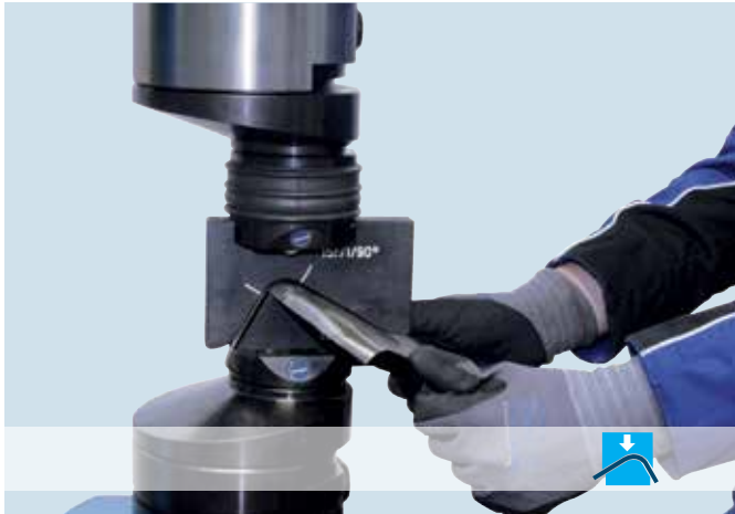
Glätten und Kalibrieren vorgeformter Werkstücke / Planishing and calibrating formed workpieces Nachformwerkzeuge / Reforming tools WT 80 S, WT 100 T, WT 150 X / NFW-102
