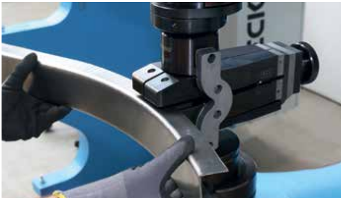
Strecken von Blechen und Profilen / Stretching sheet metal and profile sections Formwerkzeuge / Formin tools FWA 40, 60, 80, 100, 130
