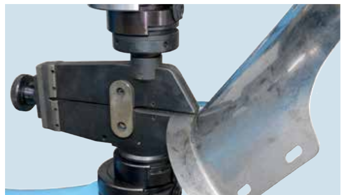
Strecken von U- und T-Profilen, ausgerüstet mit Kunststoffstollen / Stretching of U- and T-profile sections, equipped with plastic jaws Schnabelwerkzeug / Beak-shaped shrinking tool KSLR 80 T
