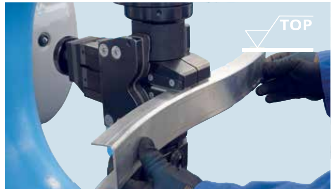
Streckwerkzeuge mit Kunststoffstollen für perfekte Oberflächen / Stretching tools with plastic jaws for perfect surfaces Formwerkzeuge / Forming tools LFR 70, 90, 120, 155
