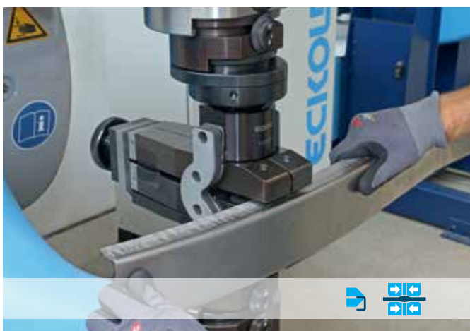
Stauchten von U- und T-Profilen, ausgerüstet mit Stahlstollen / Shrinking of U- and T-profile sections, equipped with steel jaws Schnabelwerkzeug / Beak-shaped shrinking tool KSA 80 T
