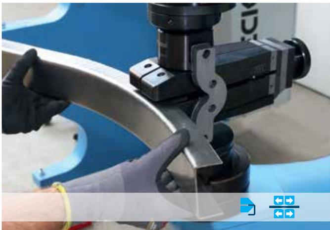
Strecken von U- und T-Profilen, ausgerüstet mit Stahlstollen /
