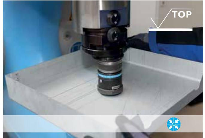
Spannen von Blechen durch konzentrisches Stauchen. Ausgerüstet mit Kunststoffstollen / *Flattening sheet metal by means of concentric skinking, equipped with plastic jaws*
